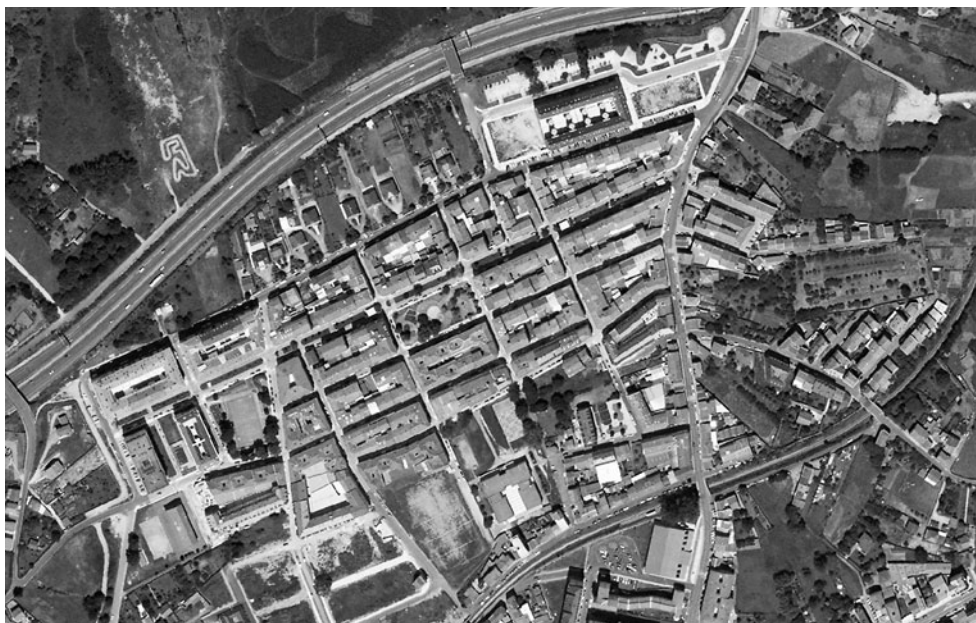
Foto 4. Discontinuidade urbana entre Santa Icia (Ferrol) ao norte e A Solaina (Narón) ao sur: en Ferrol ordenanza de vivenda unifamiliar en parcela mínima de 1.000 m 2 e polígono de solo urbano non consolidado. En Narón, edificación en altura B+4 en solo urbano consolidado
